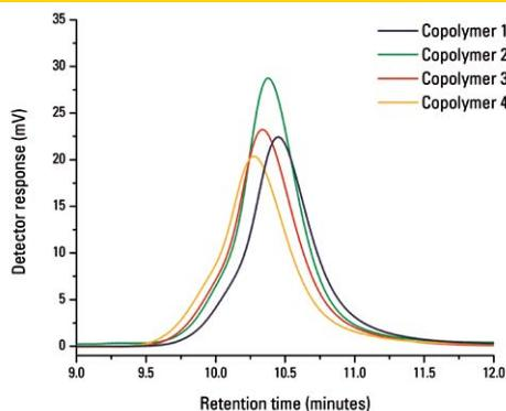
**Columns:** TSKgel SuperHZ4000, 3  $\mu$ m, 4.6 mm ID  $\times$  15 cm + TSKgel SuperHZ3000, 3  $\mu$ m, 4.6 mm ID  $\times$  15 cm + TSKgel SuperHZ2000, 3  $\mu$ m, 4.6 mm ID  $\times$  15 cm
