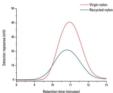
**Column:** TSKgel SuperAWM-H, 9  $\mu$ m, 6.0 mm ID  $\times$  15 cm  $\times$  2
