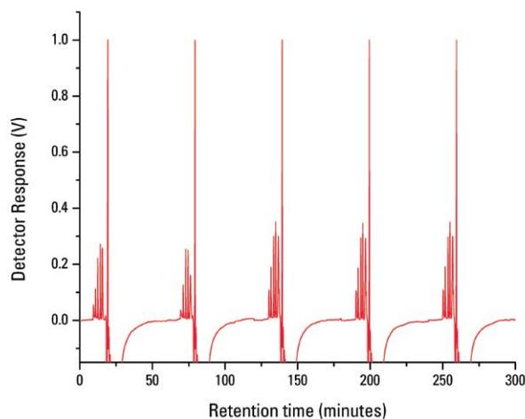
**Column:** TSKgel SuperHM-H, 3  $\mu$ m, 6 mm ID  $\times$  15 cm  $\times$  2
