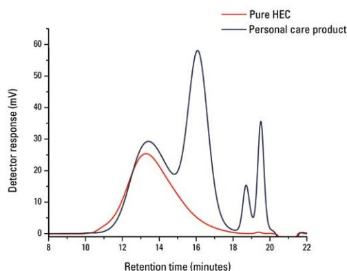
**Column:** TSKgel SuperMultiporePW-H, 8  $\mu\text{m}$ , 4.6 mm ID  $\times$  15 cm  $\times$  3
